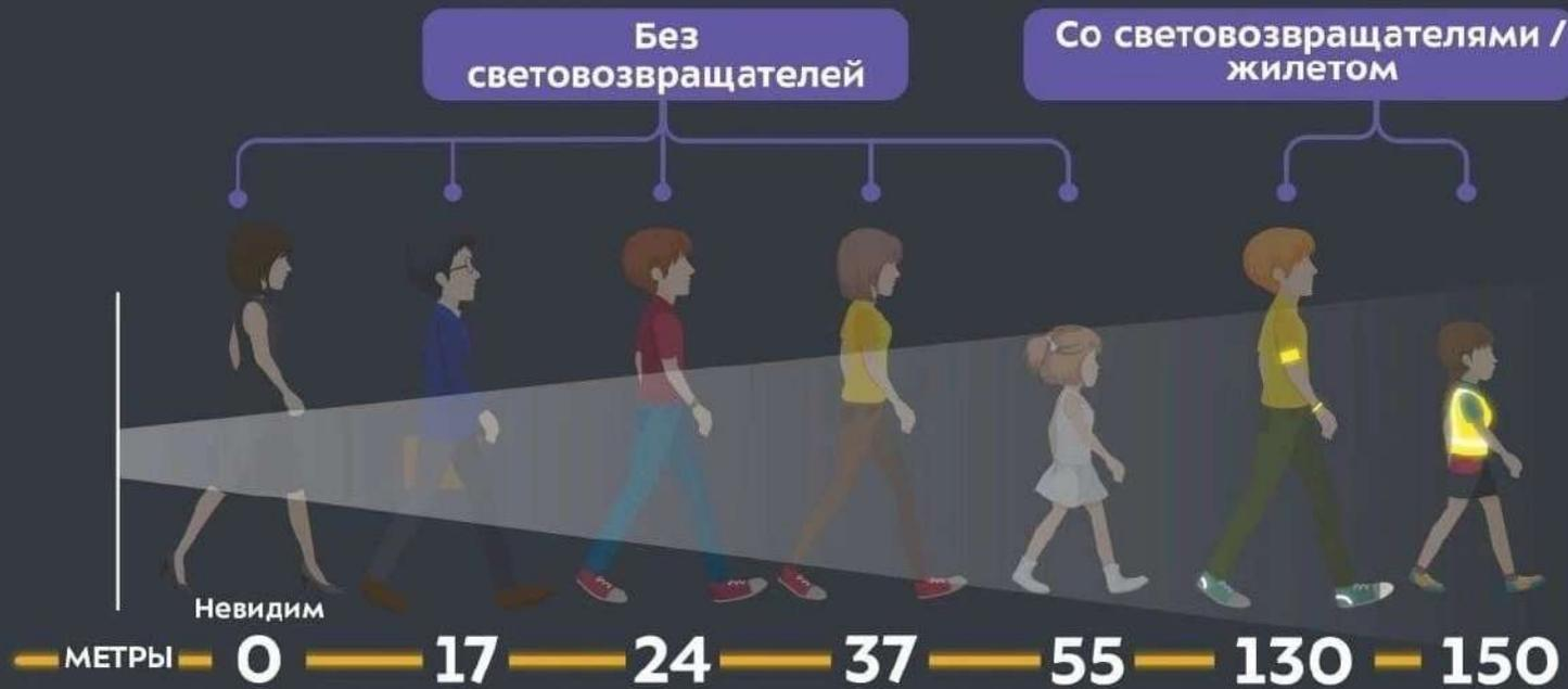
Зона торможения автомобиля со скоростью 60 км/ч
